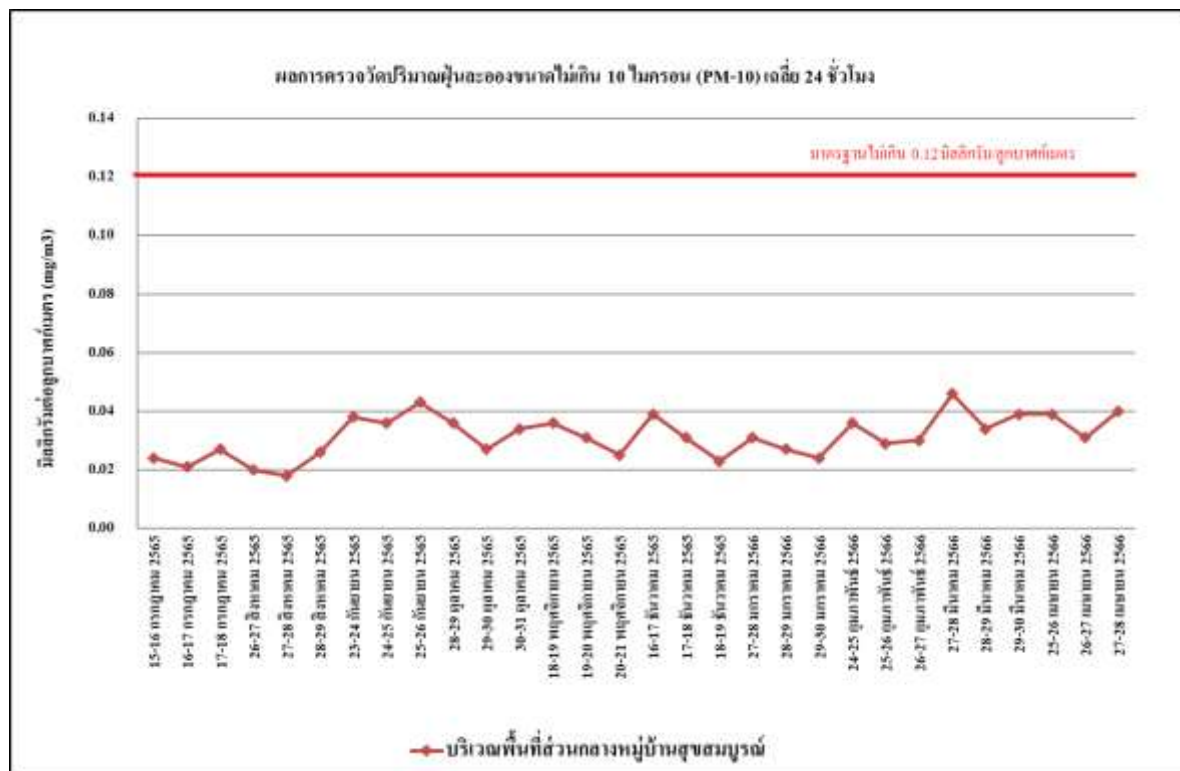
รูปที่ 4.4-18 เปรียบเทียบผลการตรวจวัดปริมาณฝุ่นละอองขนาดไม่เกิน 10 ไมครอน (PM-10) บริเวณพื้นที่ส่วนกลางหมู่บ้านสุขสมบูรณ์ ระหว่างเดือนกรกฎาคม 2565-เมษายน 2566
