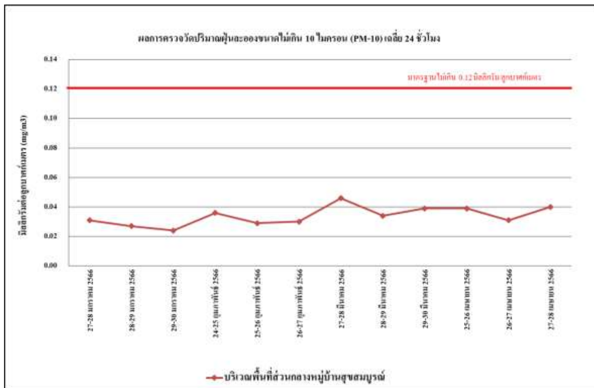
รูปที่ 4.4-4 ผลการตรวจวัดปริมาณฝุ่นละอองขนาดไม่เกิน 10 ไมครอน (PM-10) บริเวณพื้นที่ส่วนกลางหมู่บ้านสุขสมบูรณ์ ระหว่างเดือนมกราคม-เมษายน 2566
