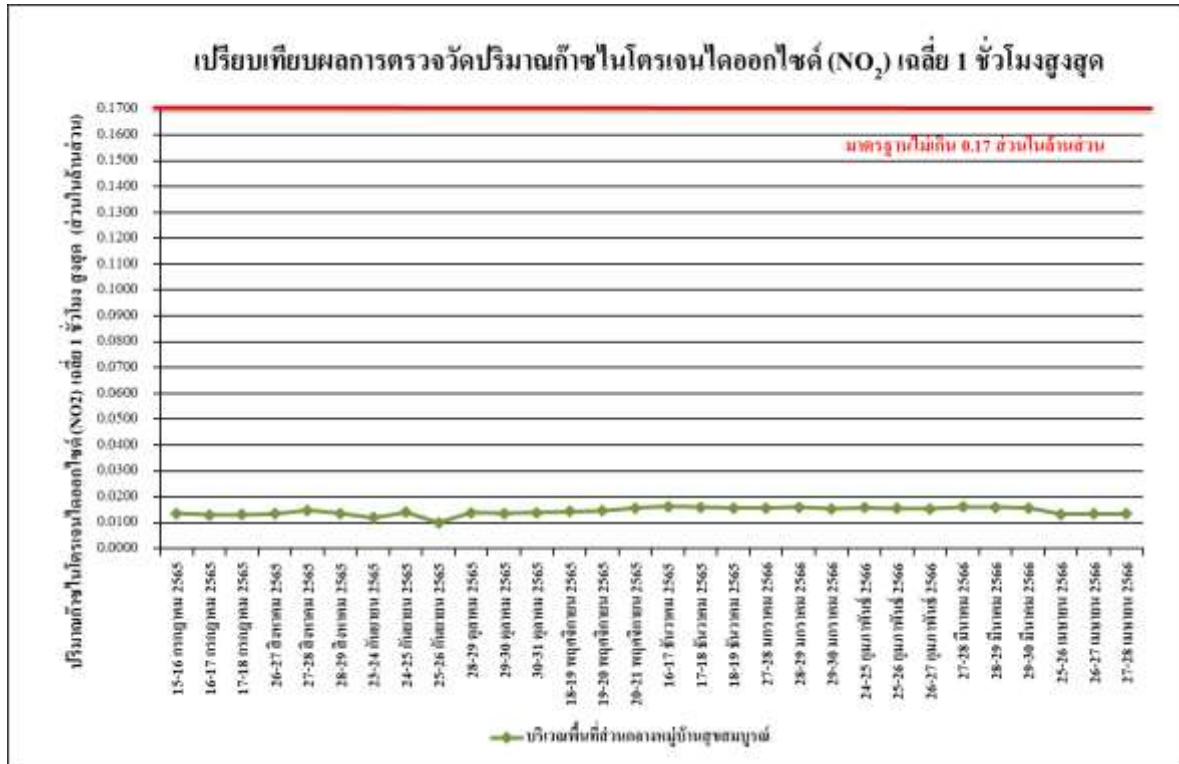
รูปที่ 4.4-22 เปรียบเทียบผลการตรวจวัดปริมาณก๊าซไนโตรเจนไดออกไซด์ (NO 2 ) เฉลี่ย 1 ชั่วโมงสูงสุด บริเวณพื้นที่ส่วนกลางหมู่บ้านสุขสมบูรณ์ ระหว่างเดือนกรกฎาคม 2565-เมษายน 2566
