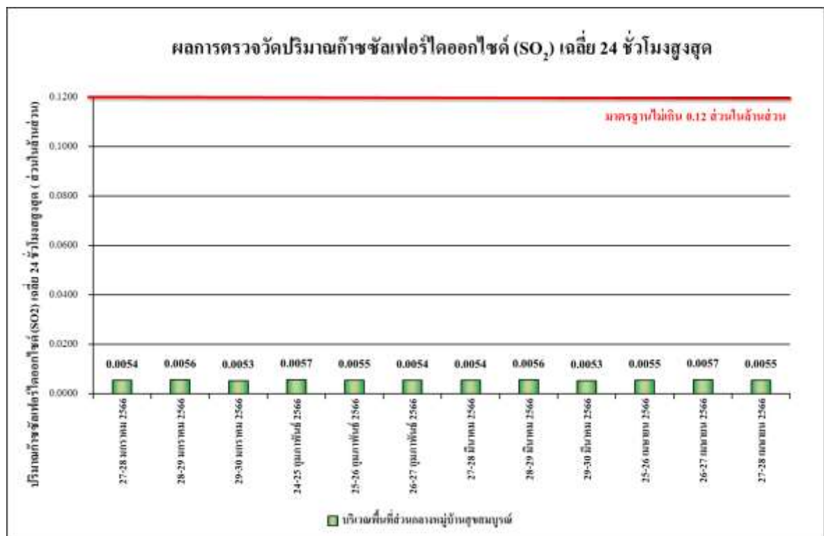
รูปที่ 4.4-10 ผลการตรวจวัดปริมาณก๊าซซัลเฟอร์ไดออกไซด์ (SO 2 ) เฉลี่ย 24 ชั่วโมง บริเวณพื้นที่ส่วนกลางหมู่บ้านสุขสมบูรณ์ ระหว่างเดือนมกราคม-เมษายน 2566
