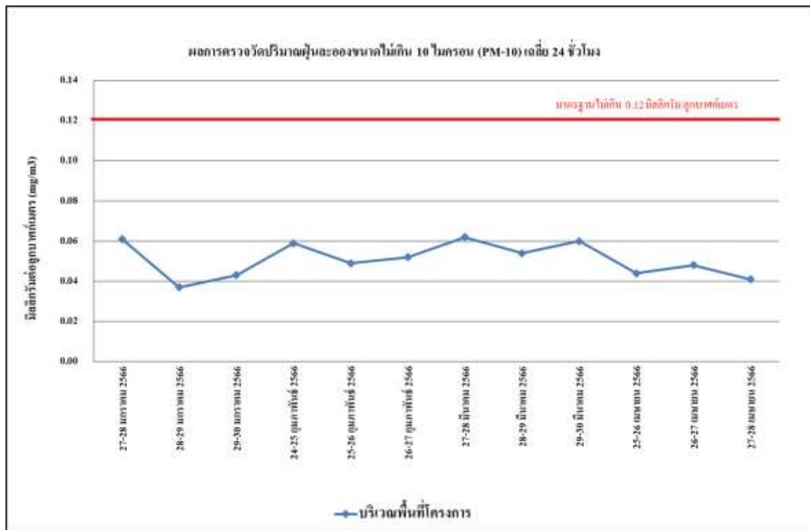
รูปที่ 4.4-3 ผลการตรวจวัดปริมาณฝุ่นละอองขนาดไม่เกิน 10 ไมครอน (PM-10) บริเวณพื้นที่โครงการ ระหว่างเดือนมกราคม-เมษายน 2566
