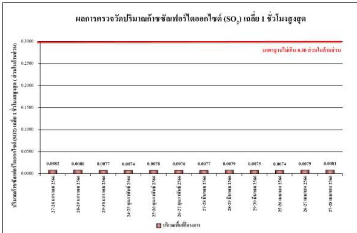
รูปที่ 4.4-11 ผลการตรวจวัดปริมาณก๊าซซัลเฟอร์ไดออกไซด์ (SO 2 ) เฉลี่ย 1 ชั่วโมงสูงสุด บริเวณพื้นที่โครงการ ระหว่างเดือนมกราคม-เมษายน 2566
